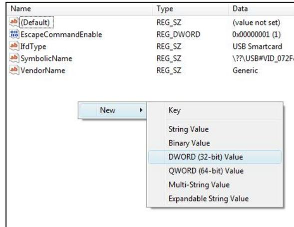
5. 要修改 EscapeCommandEnable 的值, 请双击该项, 在 Value data 内输入 1, 并将 Base 设为 Hexadecimal。
