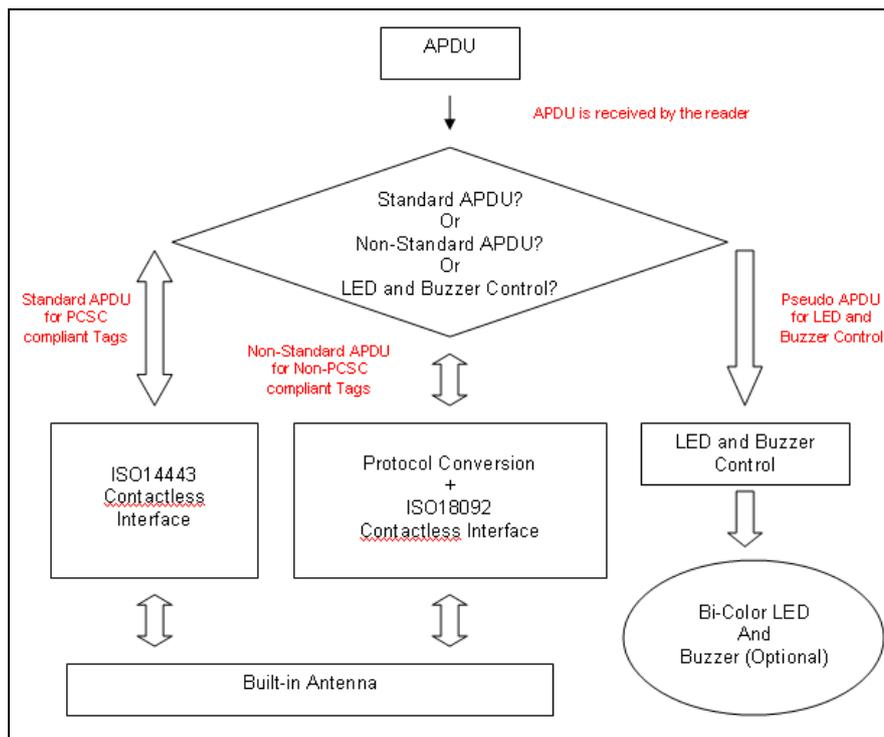
图3：非接触式应用的基本流程
