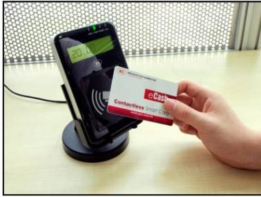
ACR122L 是一款带液晶显示屏的串口 NFC 非接触式读写器。它的开发基于 13.56 MHz 的 RFID 技术以及 ISO/IEC 18092 NFC 标准，可以支持 ISO 14443 A 类和 B 类卡、MIFARE®卡和 FeliCa 卡，以及包括全部 4 种 NFC 标签在内的多种 NFC 技术应用。
