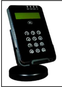
ACR1283L 是一款专为脱机使用而设计的性价比高并且功能强大的非接触式智能卡读写器。它的非接触式智能卡接口可以读写大部分符合 ISO 14443 标准的非接触式智能卡，其中包括广泛使用的 MIFARE®系列卡片。另外它具有四个内置的 SAM 卡槽，因而非常适合涉及到多张卡片，或者有不同安全性要求的各类应用。ACR1283L 丰富了用户的交互体验，除了通过 2 行图形液晶显示屏、4 个 LED 指示灯以及 1 个蜂鸣器清晰的指示应用和卡片的操作状态外，它自带的 12 键电容式触摸键盘还可以方便用户的输入。在支持脱机操作的同时，它还可以支持联机操作来实现典型的非接触式符合 PC/SC 的主机应用。
