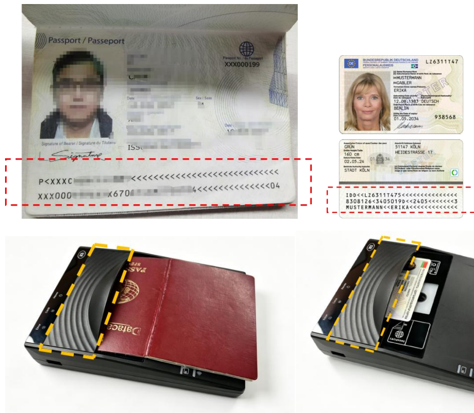
配图 1：护照平放扫描实拍、卡片平放扫描实拍
